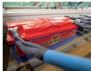
Le batterie trascorrono gran parte dei test in un bagno d'acqua a una temperatura costante di 25 gradi.
