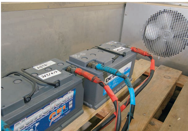
Cold Test: Le batterie sono state testate delle loro funzioni dopo essere state messe in un freezer a 0°C e quanta energia hanno potuto erogare a questa gelida temperatura
